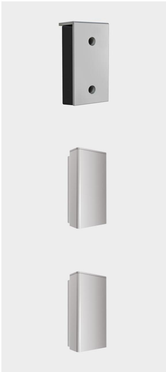
Артикул «BRSP(10)460x250x160». Построен на базе бампера 450 x 250 x 100 мм. Бампер 460 x 250 x 160 мм (внешние размеры) со стальной рабочей накладкой толщиной 10 мм. Состоит из амортизирующего по всей поверхности наполнителя (резинового бампера 450 x 250 x 100 мм), закрытого прочной внешней стальной пластиной. Установочные размеры смотрите в разделе «Чертежи».
