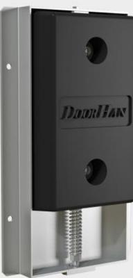
Артикул «BRM600x364x110». Построен на базе бампера 450 x 250 x 100 мм. Бампер резиновый 600 x 364 x 110 мм (внешние размеры) подвижный. Следует движениям грузового автомобиля вверх и вниз при погрузке/разгрузке. Обладает значительно большей износостойкостью благодаря подвижности. Возможно использовать только с платформами с выдвижной аппарелью длиной 1 000 мм. Установочные размеры смотрите в разделе «Чертежи».
